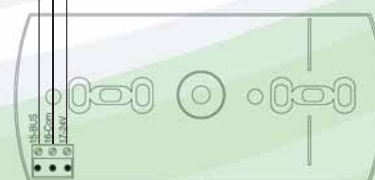
MORSETTIERA INTERNA AL CONTROLLO REMOTO
